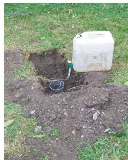
**Test de perméabilité**
